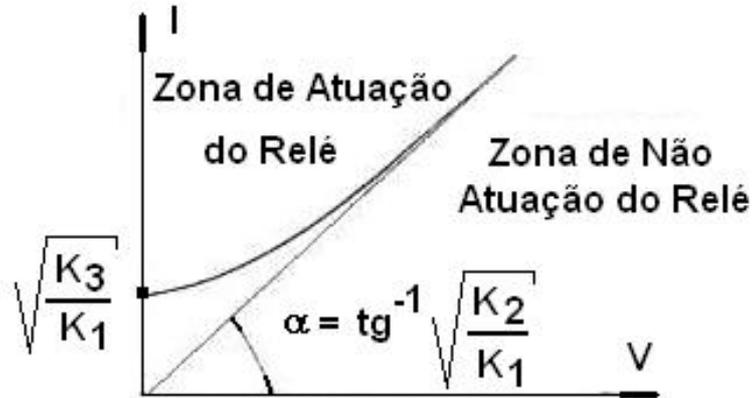
**Figura 05 – Curva de operação do relé da equação 018**
