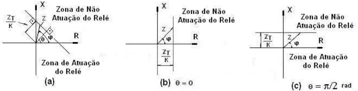
**Figura 26 – Característica angular de reatância do relé estático no plano X-R**
